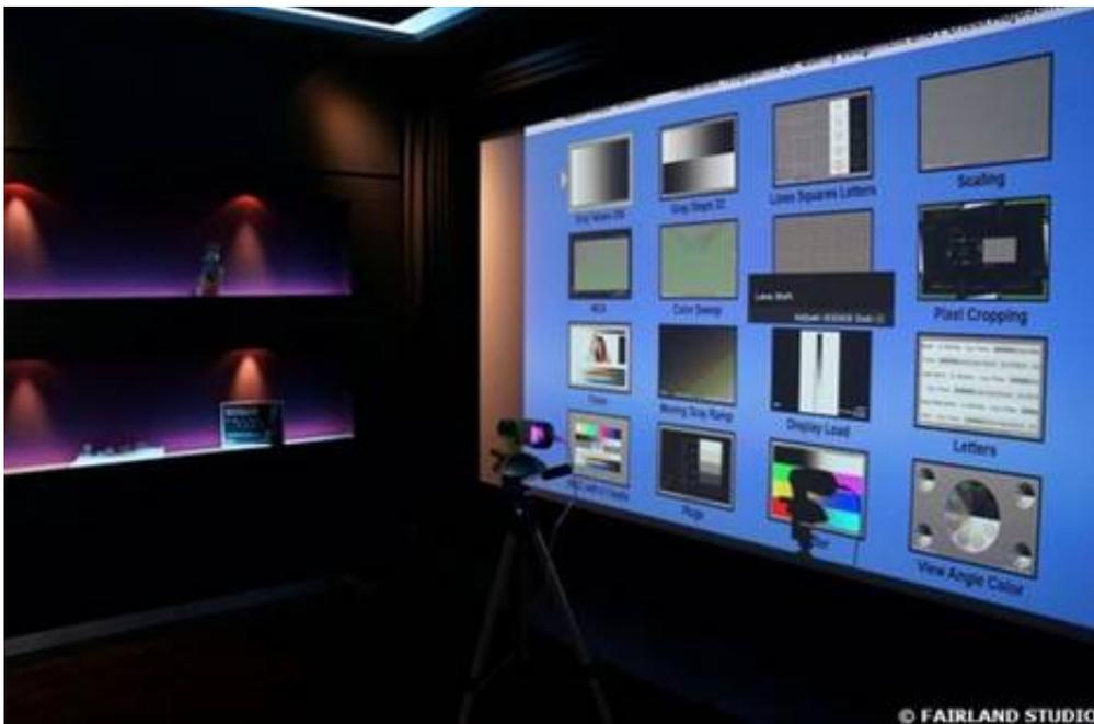
Wer absolute Perfektion wünscht, kann diese Abweichung mittels des RGB-Menüs des VPL-VW1000 in wenigen Minuten mittels Messsensor ausgleichen.
